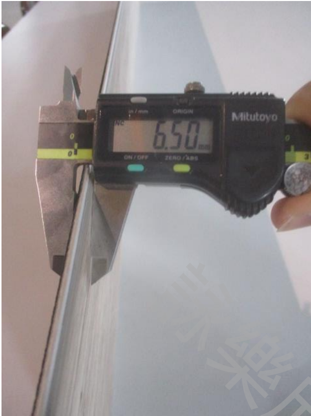
照片 1 試驗件尺寸查核(SPC 地板)
