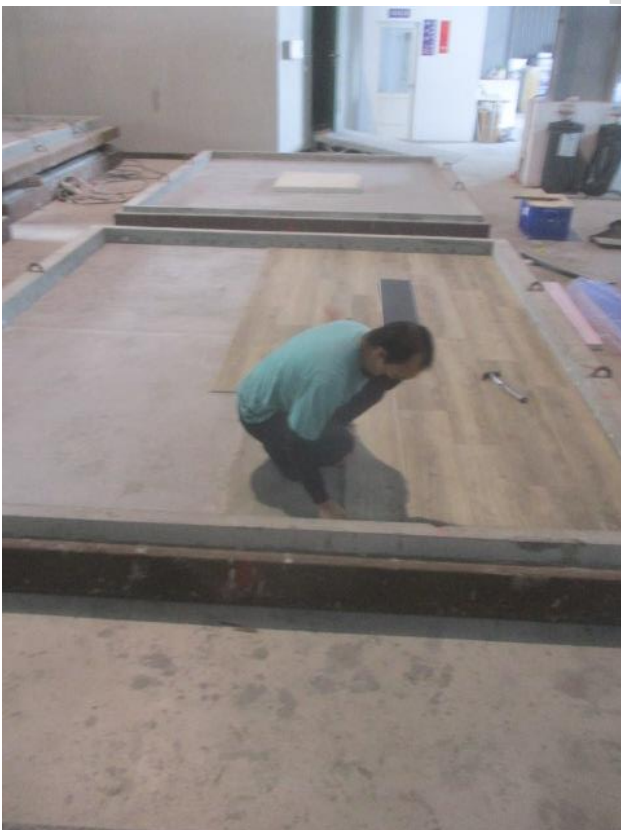
照片 3 試驗件組裝過程(鋪設 SPC 地板)
