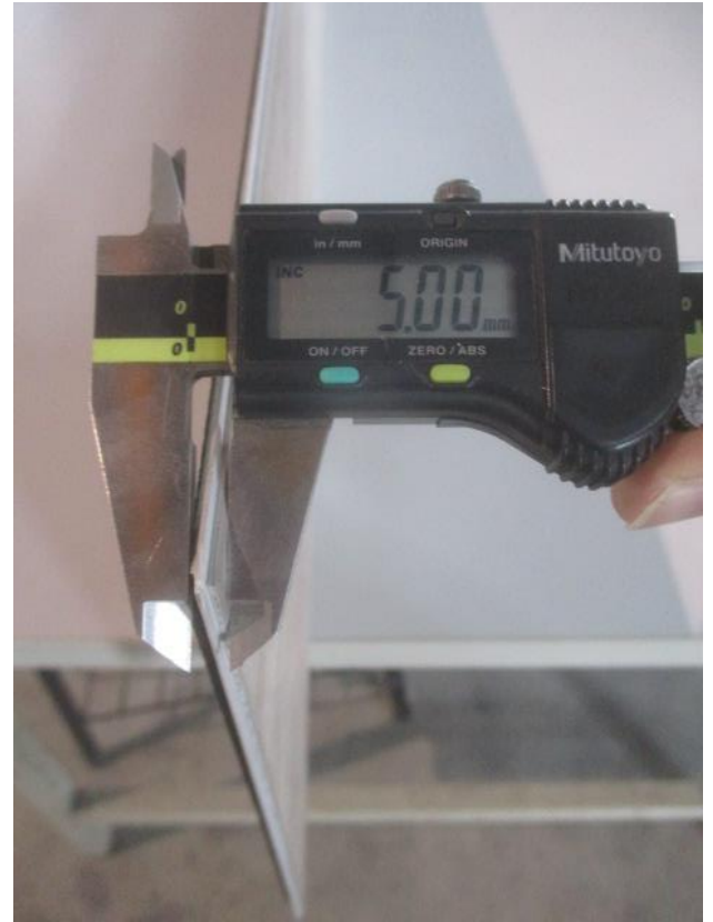
照片 2 試驗件尺寸查核(SPC 地板)
