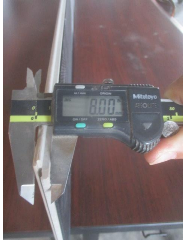
照片 2 試驗件尺寸查核(SPC 地板)
