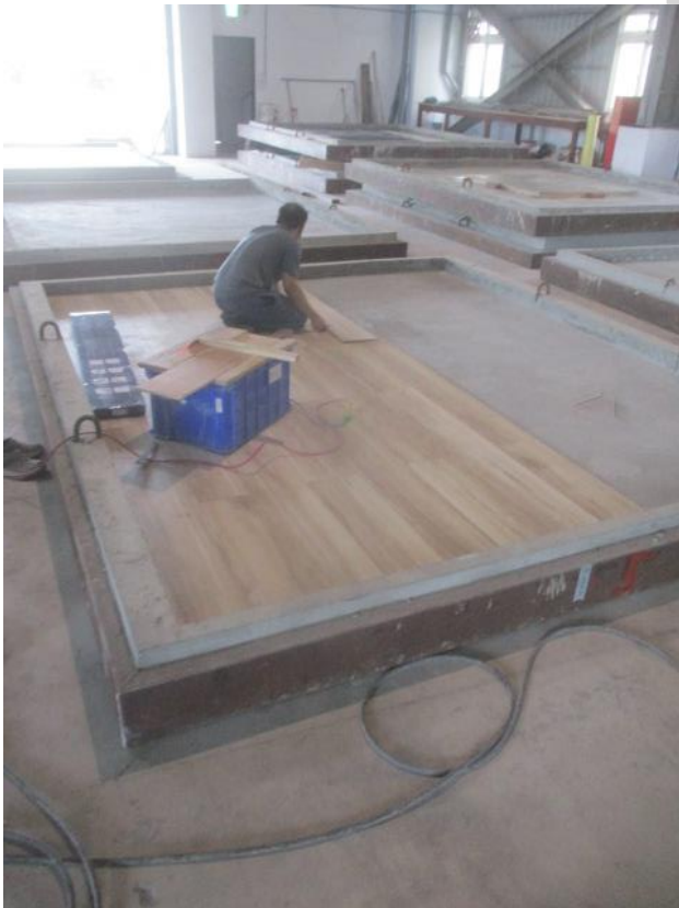
照片 3 試驗件組裝過程(鋪設 SPC 地板)
